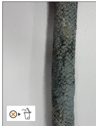
• Spuren von chemischen Produkten
