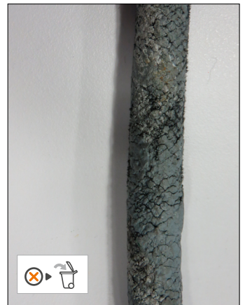
• Spuren von chemischen Produkten
