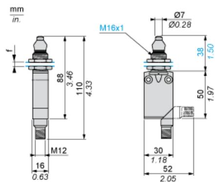
f : max. 8 mm, Schaltfelausschnitt Ø 16,5 mm, Stärke der Feststellmutter 3,5 mm.
