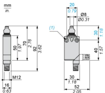
(1) 2 Befestigungslöcher Ø 4,2 mm, Senkbohrungen Ø 8 mm, Tiefe 4mm.
