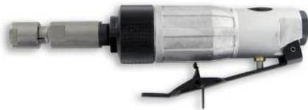
Die **Stabschleifer MG** von **Yokota** sind kompakte, leistungsstarke Druckluftschleifer für präzise Entgrat- und Schleifarbeiten an Metall, Guss und Karosseriebauteilen. Mit **6 mm Spannzange**, hoher Drehzahl und vibrationsarmer Bauweise ermöglichen sie kontrolliertes Arbeiten selbst an engen Konturen und schwer zugänglichen Stellen. Die Varianten **MG-OA** und **MG-OC** decken sowohl universelle Schleifaufgaben als auch hochdrehende Feinarbeiten zuverlässig ab.
