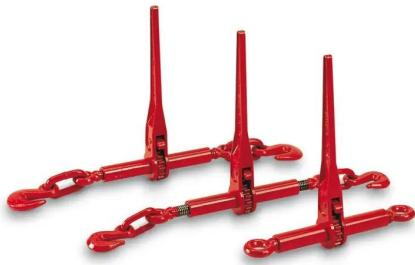
Der Ratschenspanner ist ein universelles Spannmittel, um Last und Ladungen abzuspannen oder zu verzurren. Er ist mit einem selbsthemmenden Gewinde und einer Ausdrehungssicherung ausgestattet.
