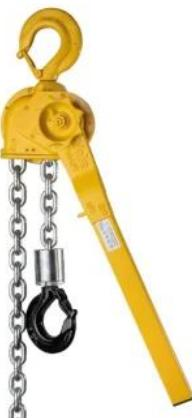
Der Yale **D85** ist ein äußerst robuster **Handhebelzug** mit verzinkter **Rundstahlkette**, entwickelt für anspruchsvolle **Industrie- und Bauanwendungen** mit Tragfähigkeiten von **750.0 kg bis 10000.0 kg**. Das geschlossene **Tempergussgehäuse** schützt die Mechanik zuverlässig vor Schmutz, Stößen und Witterungseinflüssen. Mit seiner automatisch wirkenden **Lastdruckbremse** und optionalen **Überlastsicherung** bietet der D85 höchste Sicherheit und langlebige Einsatzfähigkeit.
