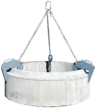
Rohrgehänge von WIMAG eignet sich für das Versetzen von Fertigschächten nach DIN 4034 Teil 1. Eine angeformte Muffe schützt die Betonteile an den wichtigen Dichtungsstellen und vermeidet Beschädigungen.
