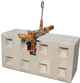
Durch eine große Hebelübersetzung erzielt der Flachgreifer von Wimag eine besonders hohe Anpresskraft. Dieser Anpressdruck erzeugt einen extrem strammen Halt und garantiert für einen sicheren Transport. Er wurde für das Handling schwerer Betonteile oder Steinplatten konstruiert. Während die eine Spannbacke über einen großen Bereich verstellt werden kann, lässt sich der Schwerpunkt über den umsteckbaren Aufhängeringen jederzeit wieder ins Lot bringen.
