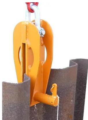
Auf Zug am Seil wird die Zange geöffnet. Der Bolzen rastet in der hintersten Stellung ein und gibt die Maulöffnung frei. Die Dielenzange kann auf die Kanal diele und über das Loch gesteckt werden. Durch seitlichen Seilzug klingt der Bolzen wieder ein und verharrt in geschlossener Stellung. Die Diele lässt sich nun sicher aufnehmen und transportieren.
