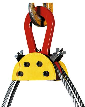
Der Lastpositionierer TF wird zum Heben von Lasten mit einem Unwuchtschwerpunkt unter Verwendung eines Doppelseils eingesetzt. Es ermöglicht eine perfekte Balance der Last. Einmal in Position, verriegelt die Klemme das Drahtseil während der Belastung in Position. Maximale Lastverteilung 30-70% der Gesamtkapazität.
