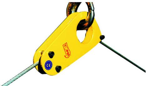
Der Lastpositionierer TC wird zum Heben von Lasten mit einem Unwuchtschwerpunkt unter Verwendung eines einzigen Drahtseils eingesetzt. Es ermöglicht eine perfekte Balance der Last. Einmal in Position, verriegelt die Klemme das Drahtseil unter Last in Position. Maximale Lastverteilung 30-70% der Gesamtkapazität.
