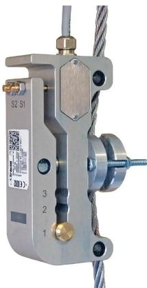
Das elektromechanische Hubkraftbegrenzer Mecha wird direkt am toten Seilende platziert. Bei Zug auf das Seil verformt sich das Messgerätgehäuses des Lastbegrenzers. Bei Überschreiten des zuvor eingestellten Schwellwertes, bewirkt die Verformung das Öffnen der im Messgerät integrierten Mikroschalter. In der Regel befindet sich der Überlastkontakt in einem Steuerkreis mit dem Endschalter "Auf".
