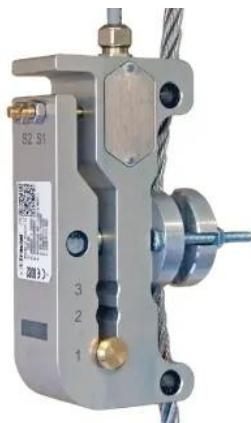
Der Tractel Lastbegrenzer dynasafe™ Mecha ist ein **mechanischer Lastbegrenzer für Drahtseil-Hubwerke**, der am **toten Seilstrang** montiert wird und bei Überschreiten eines eingestellten **Schwellwerts** über integrierte **Mikroschalter** ein „An/Aus“-Schaltsignal an den Steuerkreis ausgibt (typisch zur Unterbrechung der Hubbewegung „Auf“).
