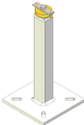
Die Kurvenumlenkrollenstütze ist für die Flachdachmontage auf Beton- oder Metallstrukturen konzipiert. Sie erlaubt die einfache Ausführung von Kurven mit variabler Öffnung und ermöglicht eine Umlenkung der Seilführung zwischen 10° und 120°.
