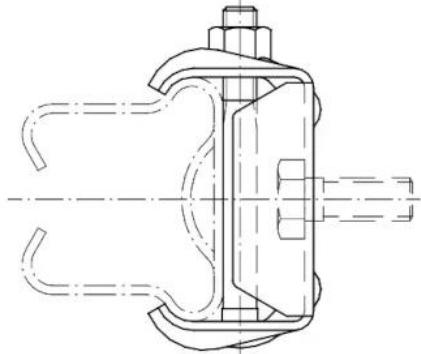
Die Tractel **FABA A11 Klemmen** dienen zur **sicheren Befestigung** der **A11 Steigschutzschiene** an den vorgesehenen **Halterungen**. Sie stellen eine **form- und kraftschlüssige Verbindung** sicher, damit der **Fangwagen** über den gesamten Steigweg störungsfrei geführt wird. Als Systembauteil des **FABA A11** sind die Klemmen für Steigschutzanlagen nach **EN 353-1** ausgelegt.
