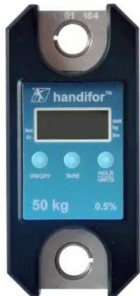
Die Tractel Kleinwaage HANDIFOR™ ist eine kompakte elektronische Kraftmessvorrichtung zum Wiegen hängender Lasten und zum Messen von Zugkräften, ideal für schnelle Kontrollen in Wareneingang, Versand und Instandhaltung. Je nach Ausführung deckt sie **20 kg bis 200 kg** ab und bietet praxisnahe Funktionen wie **Tara**, **Spitzenwert/Hold** und **Einheitenumschaltung** (kg/lbs bzw. daN).
