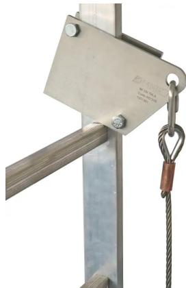
Die obere Anschlageinrichtung mit zwei Anschlagösen muss den Kräften eines Absturzes standhalten. Dabei ist die Befestigungsmethode – Typ, Abmessungen und Material – am oberen Ende der Stopcable™-Laufsicherung klar zu definieren, insbesondere wenn sie nicht direkt an der Leiter befestigt ist.
