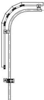
Der Tractel **FABA A11 Gebogener Überstieg** ist eine Ausstiegslösung für Steigschutzanlagen, die einen **sicheren und ergonomischen Übergang** von der Leiter auf Dach- oder Plattformflächen ermöglicht. Durch die gebogene Geometrie wird der Anwender beim Ausstieg **mindestens 892 mm** von der Absturzkante positioniert und bleibt bis zum vollständigen Übertritt gesichert. Der Überstieg ist eine **Systemkomponente nach EN 353-1** und optimal auf das **FABA A11 Steigschutzsystem** abgestimmt.
