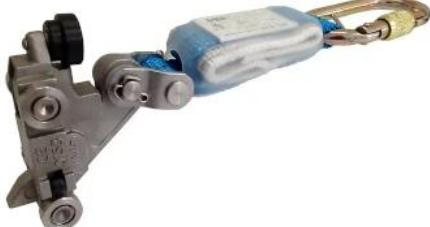
Der **FABA-Fangwagen AL-D** ist ein mitlaufendes **Auffanggerät** für Tractel **FABA A12-** und **FABA AL2-**Steigschutzsysteme und dient der **Absturzsicherung** an vertikalen Steigwegen. Er folgt der Bewegung des Anwenders und **blockiert im Sturzfall automatisch**, um die Fangstoßkräfte zu begrenzen. Die Ausführung ist nach **EN 353-1:2018** zertifiziert und für Benutzer bis **150 kg** inklusive Ausrüstung zugelassen.
