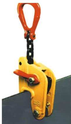
Automatische, selbstschließende Klemme, geeignet zum Heben von Platten, Stahlträgern, Profilen und Stahlkonstruktionen aus jeder Position. Heavy Duty Ausführung. Die Klemme verfügt über eine Sicherheitsfeder für kontinuierlichen Anpressdruck und hinterlässt je nach Gewicht der Last nur auf einer Seite eine Markierung.
