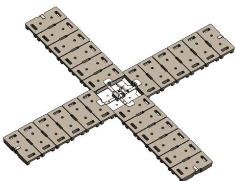
Das mobifor™ ist ein revolutionärer, tragfähiger Anschlagpunkt für die Montage auf Flachdächern und Bereichen mit Absturzrisiko. Das Set besteht aus 24 Betongewichten, die auf vier Tragarmen positioniert sind. Die Arme sind in der Mitte durch eine Verbindungsplatte verbunden, die mit einem flexiblen, drehbaren Anschlagpunkt mit Fallämpfer ausgestattet ist.
