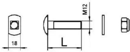
Hammerkopfschraubensatz für die Befestigung der FABA A12 Schiene
