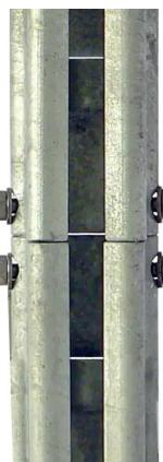
Die Verbindungsbolzen werden in die bereits montierte FABA-Steigschutzschiene handfest angeschraubt. Die nächste Schiene wird aufgesetzt und mit den verbleibenden 2 Schrauben handfest angeschraubt. Nach dem Ausrichten des Steigganges alle 4 Schraubverbindungen fest anziehen.
