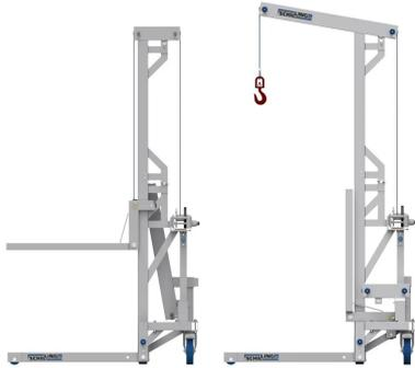
Der Multilift von Schilling ist ein wahres Multitalent in Sachen Heben. Er lässt sich, je nach Bedarf als Kleinkran oder auch als Materiallift aufbauen. Alle Teile sind durch Steckbolzen gesichert und schnell zerlegbar. Ein Umbau von Kleinkran auf Materiallift ist schnell durchgeführt. Nur wenige Teile müssen hierfür ausgetauscht werden.
