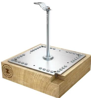
Der aus Edelstahl, speziell für Holzuntergründe (dmin.= 22mm), konstruierte SEKURANT® X2 TYP 5 ist nach EN 795: 2012 und CEN/TS 16145: 2013 geprüft und zertifiziert. Er dient als Einzelanschlagpunkt für PSAgA sowie als Unterkonstruktion von Seil- und Schienensystemen, wie z.B. dem SKYLINE oder dem SKYRAIL System. Die geschweißte Stütze wird einbaufertig mit 32 St. Holzschrauben geliefert, sodass die Montage äußerst zeitsparend ist.
