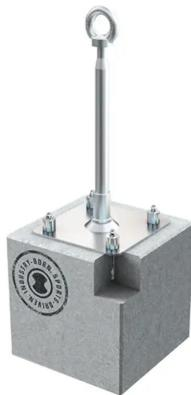
Die vormontierte, schraubbare Stütze wird einbaufertig mit einem Schwerlastanker inkl. Abreißmutter geliefert, sodass die Montage äußerst zeitsparend ist. Der leichte, handliche Einzelanschlagpunkt ist in Höhen bis 1000mm erhältlich und eignet sich daher für Dämmdicken bis 800mm.
