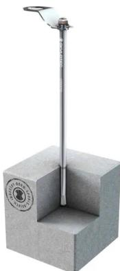
Der aus Edelstahl, speziell für Betonuntergründe (Güte min. C20/25, dmin.=140 mm), konstruierte SEKURANT® PIN TYP 40 verfügt über eine Europäisch Technische Bewertung (ETA -16/0790) und ist nach EN 795: 2012, CEN/TS 16415: 2013 geprüft und zertifiziert. Er dient als Einzelanschlagpunkt für PSAgA sowie als Unterkonstruktion von Seil- und Schienensystemen, wie z.B. dem SKYLINE oder dem SKYRAIL System.
