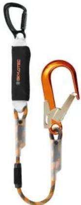
Verbindungsmittel mit Falldämpfer dienen zur Verbindung der Auffanggöse eines Auffanggurtes (EN 361) mit einem Anschlagpunkt (EN 795). Sie dürfen eine Gesamtlänge von max. 2 m haben. Der Falldämpfer dient zur Energieabsorbierung in Absturzsicherungssystemen.
