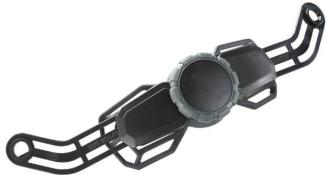
Das Nackenband des INCEPTOR GRX ist stufenlos verstellbar, deckt mühelos Kopfumfänge von 54 bis 63 cm ab und sorgt für optimale Passform und hohen Tragekomfort. Der ADJUSTER sitzt tief am Hinterkopf und gibt ergonomischen Halt. An jedem INCEPTOR GRX-Helm ist der ADJUSTER problemlos austauschbar.
