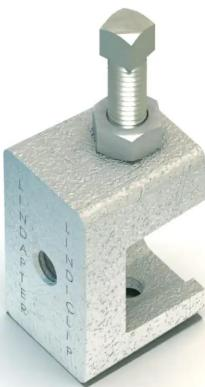
Die Trägerklammer LC LindiClip eignet sich dazu, gering belastete Gewindestangen oder Kabelschellen an Trägern abzuhängen. Hierbei sind sowohl parallele als auch geneigte Flansche erlaubt. Die Trägerklemmen sind mit einer hochfesten Stellschraube ausgestattet die mit ihrer Ringschneide für einen festen Sitz sorgt. Die Klemme selbst ist aus Temperguss gefertigt und für hohe Leistung und Korrosionsschutz galvanisch verzinkt.
