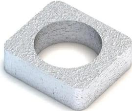
Typ W ist ein Einlegeteil zum Ausfüllen der Vertiefung von Typ A. Dadurch entsteht eine ebene Auflage zum Anziehen der Schraube bzw. Mutter.
