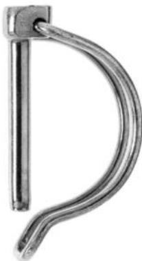
Rohr-Klappsplinte von Kleinsorge sind verzinkte Sicherungselemente aus Stahl zur schnellen Befestigung und Sicherung von Rohren, Bolzen und Stangen. Sie werden durch Auf- oder Durchstecken montiert, wobei der runde Federring überklappt und das Bauteil zuverlässig gegen unbeabsichtigtes Lösen sichert. Dank verschiedener Durchmesser und Längen sind sie in Maschinenbau, Fahrzeug- und Landtechnik vielseitig einsetzbar.
