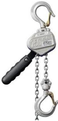
Der **HADEF Ratschzug 53/22A** ist ein kompaktes Hebelzugerät zum **vertikalen Heben und Senken** sowie zum **Ziehen und Spannen** von Lasten bis zur jeweiligen **Nenntragfähigkeit** (250–1500 kg), wobei eine **Lastdruckbremse** das selbsttätige Senken der Last verhindert.
