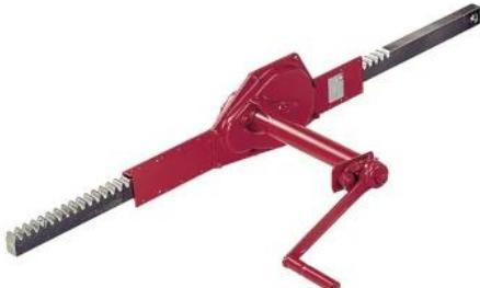
Die **Zahnstangenwinde 1685** von Haacon ist eine robuste, mechanische Winde zum sicheren **Heben, Senken und Positionieren** schwerer Lasten bis 10 t. Ihre **selbsthemmende Sicherheitskurbel** ermöglicht kontrollierte Hubbewegungen und hält die Last zuverlässig in jeder Position. Dank vielseitiger **Zug- und Druckausführung** sowie anpassbaren Zahnstangen- und Hublängen eignet sie sich ideal für Industrie, Montage- und Serviceeinsätze.
