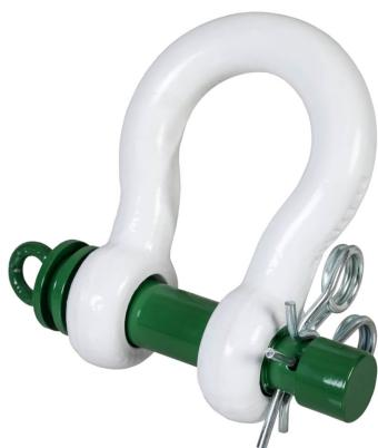
Der **Green Pin ROV Polar Schäkel P-5363** ist ein geschweifter **Release-ROV-Schäkel** der Gütekasse 8 mit zwei **Spring Pins** für sichere Unterwasser-Hebevorgänge. Er besteht aus **vergütetem legiertem Stahl** in **polar quality** und ist für extreme Temperaturen von **-60°C bis +200°C** ausgelegt. Der Schäkel ist speziell für **axiale Belastung** konstruiert und eignet sich für anspruchsvolle **Subsea- und Offshore-Anwendungen**.
