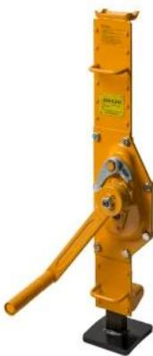
Die **Stahlwinde DK** von Delta ist eine robuste **Zahnstangenwinde** zum Heben und Abstützen schwerer Lasten bis 20 t. Sie ermöglicht das Anheben über **Kopf** und **Klaue**, wobei an der Klaue **70 % der Nennlast** verfügbar sind. Dank **gehärteter Stahlkonstruktion, Sicherheits- oder Ratschenkurbel** und stabiler Standfläche eignet sie sich ideal für Montage-, Bau- und Serviceeinsätze.
