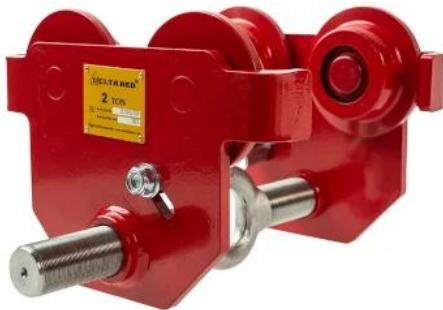
Die **DELTA RED Laufkatze** ist ein manuell verfahrbare **Handfahrwerk** für **I- und H-Träger** mit Tragfähigkeiten von ca. **0.5–10.0 t** und einem großen Einstellbereich bis **305.0 mm**. Dank **kugelgelagerter, dauerhaft geschmierter Räder** und der **einstellbaren Trägerbreite** lässt sich die Last sanft und präzise verfahren. **Sicherheitsbügel** und **Kippschutz** sorgen für hohe Betriebssicherheit, wodurch das Fahrwerk ideal für Werkstatt, Montage und industrielle Anwendungen ist.
