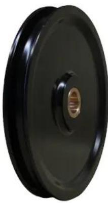
Die **Seilscheiben 615** bestehen aus robustem **Stahl** mit vollem Boden und einer selbstschmierenden **Buchse**, ausgelegt für Drahtseile nach früher **DIN 82236**. Sie sind passend zu **Hangerblock 603**, **Hangerblock 605** und **Ladeblock 611** und eignen sich für Anwendungen mit hohen **Seilzugkräften**. Die normgerechte **Rillengeometrie** (Rillengrund-Ø = 14 × Seil-Ø) gewährleistet eine sichere und seilschonende Führung.
