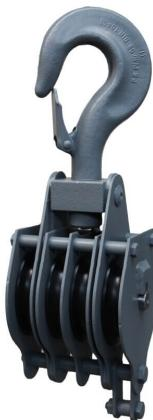
Drahtseilkloben mit drehbarem Lasthaken DIN 15401 mit Hakensicherung. Eingebaut sind die Drahtseilrollen Nr. 37/100 - 150 mm aus Polyamid bzw. Nr. 37/100 - 480 mm aus Stahl mit Gleit-, Walzen- oder Kugellagerung.
