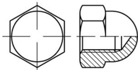
**Sechskant-Hutmuttern** nach **DIN 1587** in hoher Form, gefertigt aus **Messing** mit **galvanischer Vernickelung**. Diese Muttern verbinden dekorative Optik mit gutem **Korrosionsschutz** und sind auch für Anwendungen mit elektrischer Leitfähigkeit geeignet.
