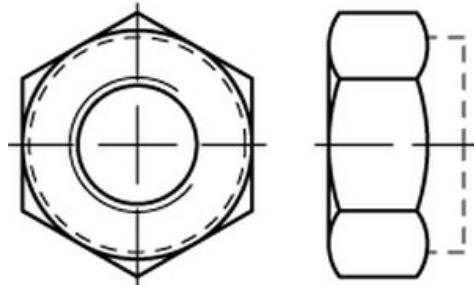
**Sechskantmuttern mit Klemmteil nach ISO 10511.** Ausführung in **Messing**, niedrige Form, mit **nichtmetallischem Einsatz** für sichere Klemmwirkung. Ideal für Anwendungen mit **guter Korrosionsbeständigkeit** und elektrischer Leitfähigkeit. **RoHS-konform**.
