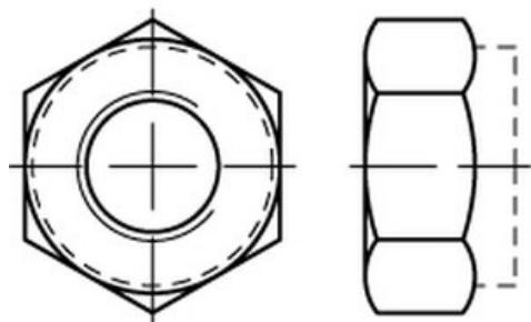
~DIN 985 Messing Sechskantmuttern mit Klemmteil, mit nichtmetallischem Einsatz, niedrige Form
