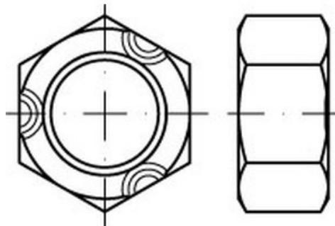
**Sechskantmuttern mit Klemmteil nach ISO 7042.** Ausführung aus **Edelstahl A4** als **Ganzmetall-Klemmmuttern**, mit hoher Korrosions- und Säurebeständigkeit für den Einsatz im Außen- und Seewasserbereich.
