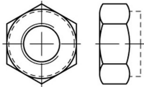
**Sechskantmuttern mit Klemmteil nach ISO 10511.** Ausführung in **Edelstahl A4**, niedrige Form, mit **nichtmetallischem Einsatz** für sichere Klemmwirkung. Besonders geeignet für Anwendungen mit hoher **Korrosions- und Säurebeständigkeit** (z. B. Offshore oder Chemieindustrie).
