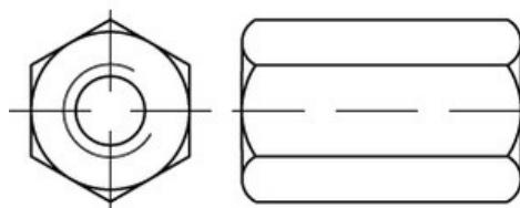
**Sechskantmuttern** nach **DIN 6334** sind besonders **lange Muttern** mit einer Höhe von **3d**. Durch ihre Bauform werden sie auch als **Muffen** bezeichnet und eignen sich ideal zum Verlängern von Schraubenverbindungen oder zum Verbinden von **Gewindestangen**. In der Ausführung aus **Edelstahl A4** bieten sie eine hervorragende **Korrosionsbeständigkeit**, auch in aggressiven oder maritimen Umgebungen.
