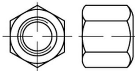
**Sechskantmuttern** nach **DIN 6330** gehören zu den **schweren Muttern** und besitzen eine Höhe von **1,5 d**. In der Ausführung **Form B** verfügen sie über eine **kugelige und ebene Auflagefläche**, die eine gleichmäßige **Kraftverteilung** ermöglicht und eine sichere Verbindung gewährleistet. Gefertigt aus **Edelstahl A4** bieten sie eine ausgezeichnete **Korrosionsbeständigkeit**, auch in aggressiven oder maritimen Umgebungen.
