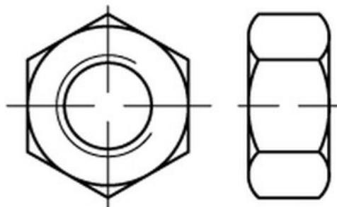
ISO 4032 A2 – Sechskantmuttern aus **Austenit-Edelstahl (A2)**, naturfarben, korrosionsbeständig
