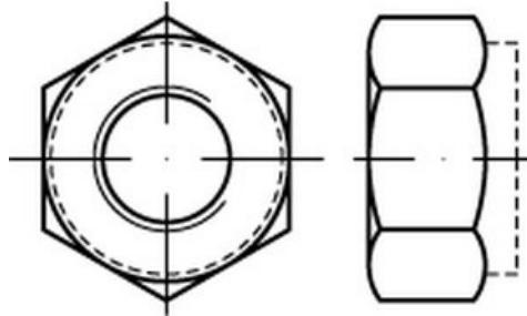
**Sechskantmuttern mit Klemmteil nach ISO 7040.** Ausführung in **Edelstahl A2-70**, hohe Form, mit **nichtmetallischem Einsatz** aus **wärmestabilisiertem Polyamid (WS)**.
