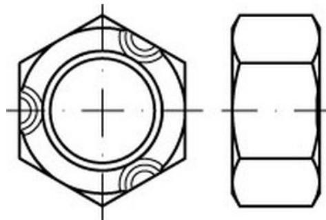
**Sechskantmuttern mit Klemmteil nach ISO 7042.** Ausführung aus **Edelstahl A2** als **Ganzmetall-Klemmmuttern**, vibrationssicher und für dauerhafte Schraubverbindungen geeignet.
