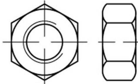
**ISO 4032 A2 Links – Sechskantmuttern** aus austenitischem Edelstahl **A2** mit metrischem Linksgewinde, unveredelt und **naturfarben**.
